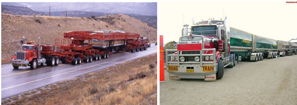
Рис.6. Автопоїзд з багатоколісним керованим причепом - трейлером на дорогах Німеччини та автопоїзд з багатьма керованими причепами на дорогах США
