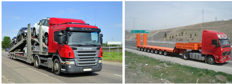
Рис.9. Автовоз-напівпричіп вантажністю 25 т, завдовжки 20 м і автотрейлер для перевезення великовагових і не стандартних вантажів та спецтехніки
