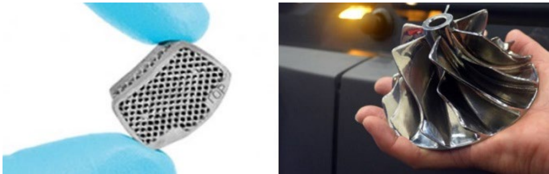
Рисунок 4 - Приклади металевих деталей, виготовлених за методом SLS-друку
