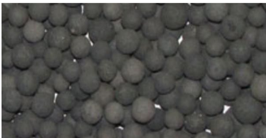
Рисунок 1 – Інтерметалідний паладієвий каталізатор ПК-3-III
