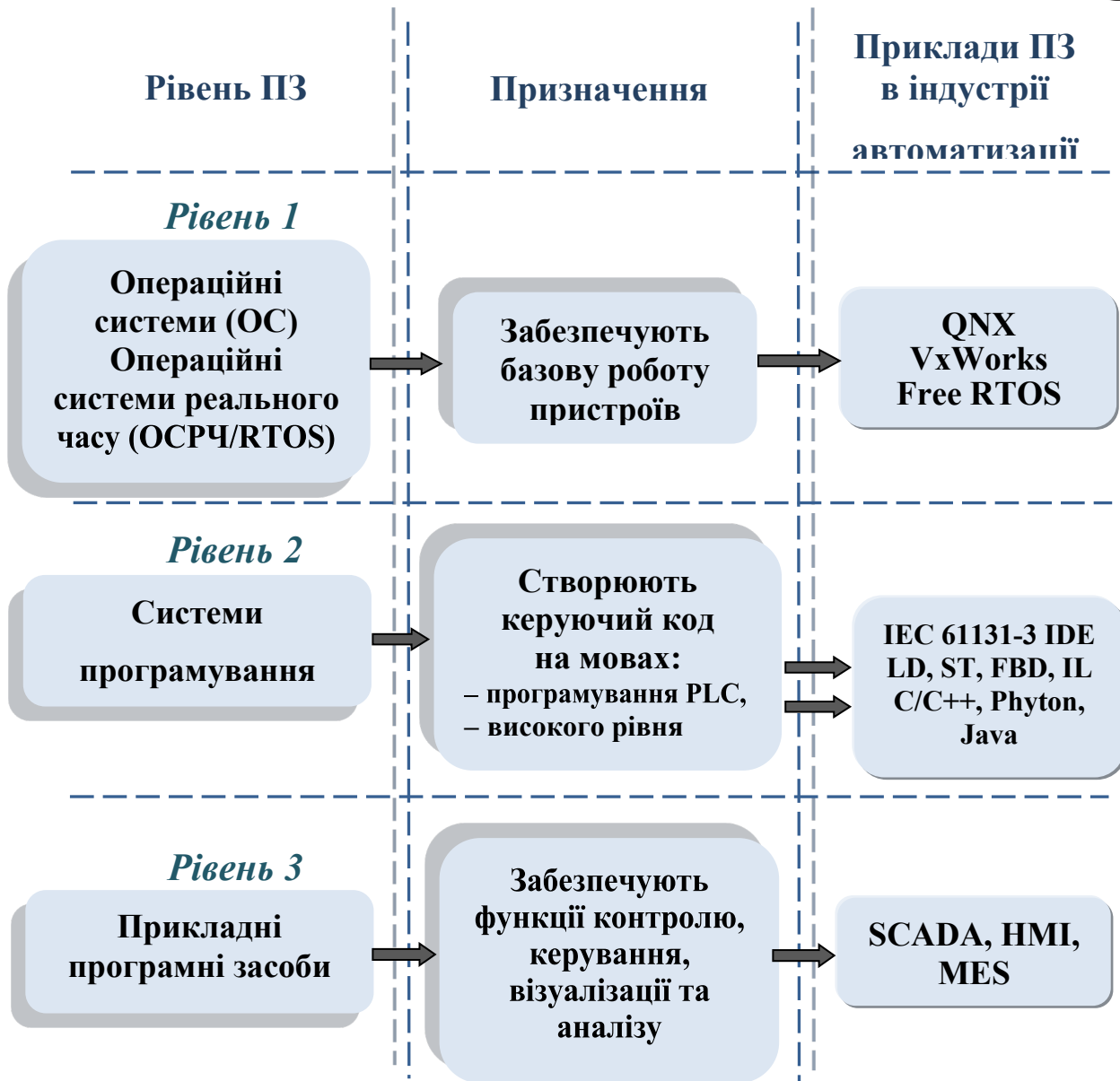
Рисунок 1 - Програмне забезпечення (ПЗ) у промислових автоматизованих системах керування технологічними процесами
