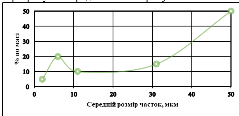
Рисунок 1– Дисперсний склад пилу у відцентровому циклоні
